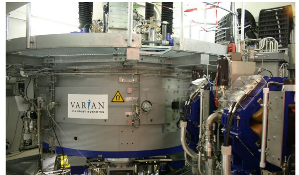
Das zu überwachende Transportgut: Cyclotron, die Weltneuheit von Varian Medical Systems – ein supraleitender Protonenbeschleuniger zur Behandlung von Krebserkrankungen.
