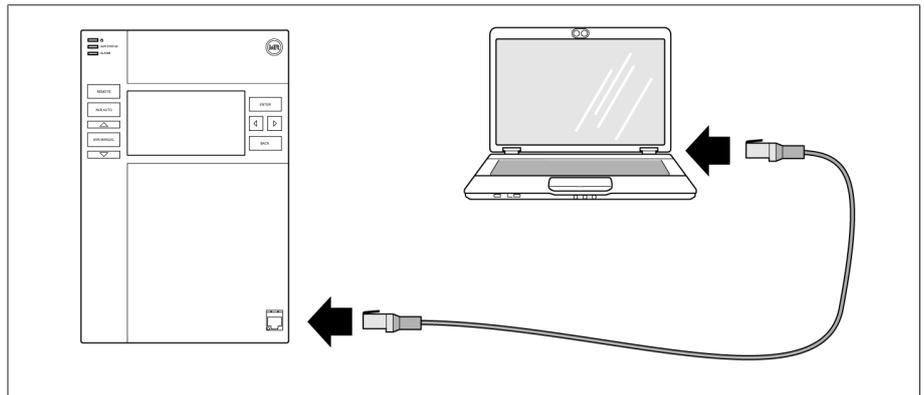
Abbildung 58: Verbindung über die Frontschnittstelle herstellen
