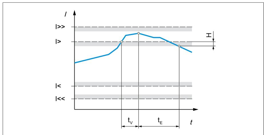
Abbildung 48: Stromüberwachung mit beispielhafter Überschreitung des Grenzwerts  $I_{>}$
