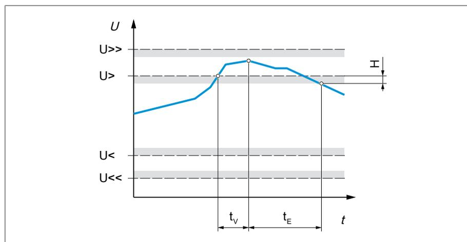
Abbildung 47: Spannungsüberwachung mit beispielhafter Überschreitung des Grenzwerts Überspannung  $U_{>}$
