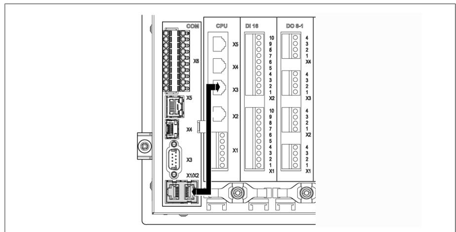
Abbildung 57: Patchkabel auf der Rückseite
