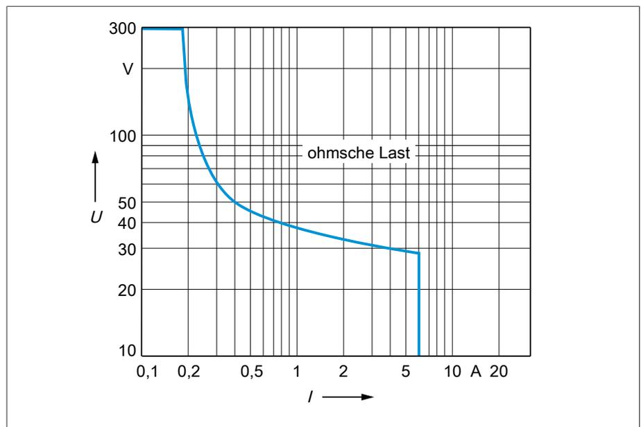
Abbildung 59: Kontaktbelastbarkeit der digitalen Ausgänge bei ohmscher Belastung
