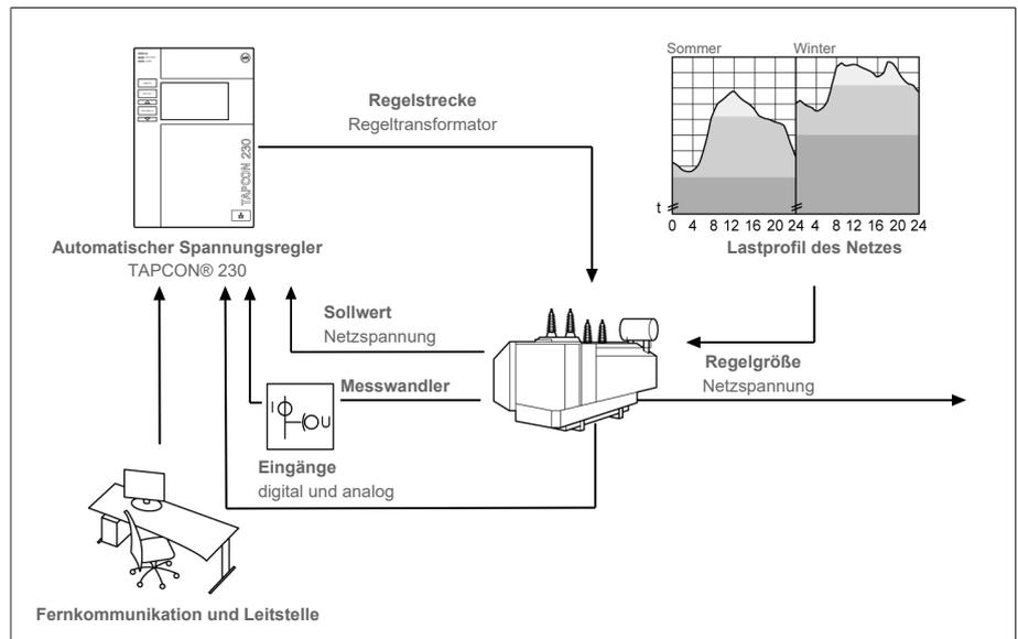
Abbildung 1: Übersicht zur Spannungsregelung
