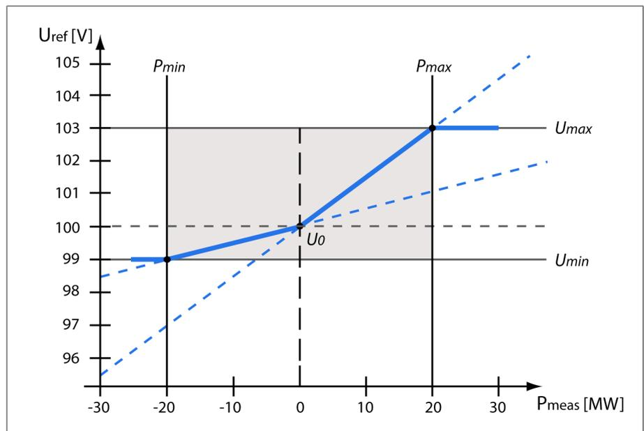
Abbildung 49: Wirkleistungsabhängige Anpassung des Spannungssollwerts
