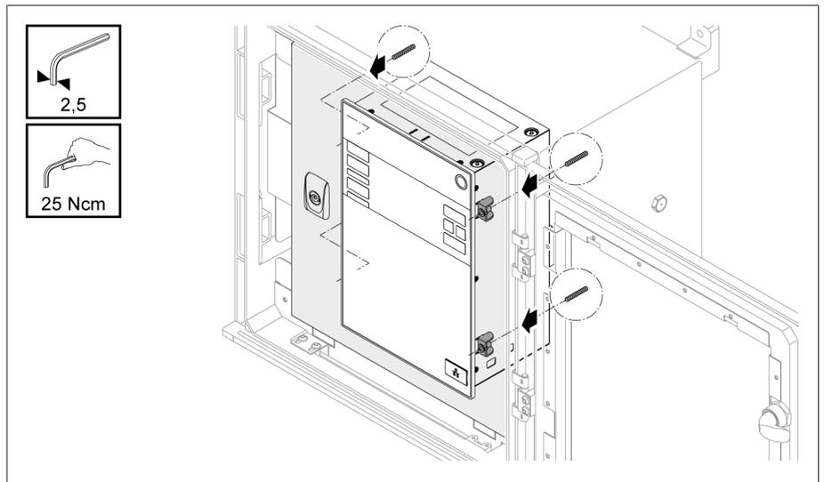
Abbildung 25: Gerät befestigen
