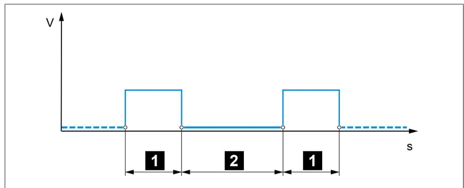
Abbildung 56: Schaltimpulsdauer und Schaltimpulspause
