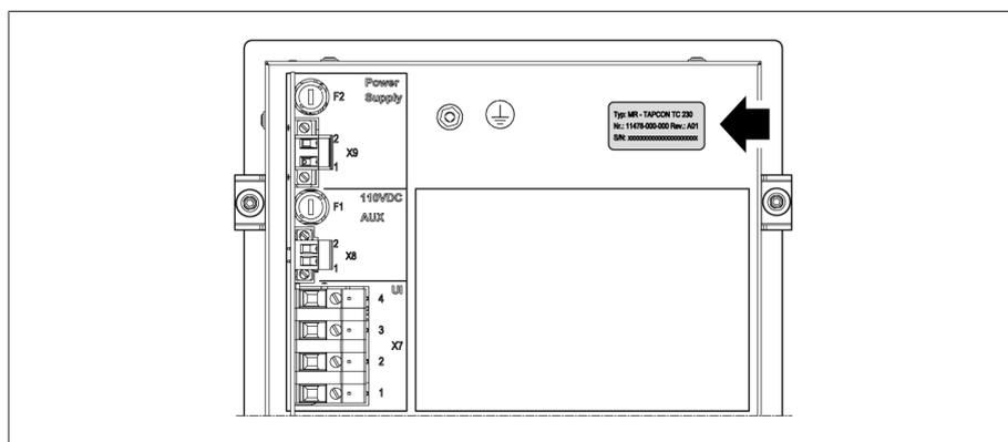
Abbildung 6: Typenschild auf der Rückseite des Geräts
