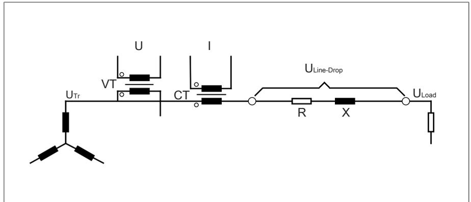
Abbildung 53: Ersatzschaltung der R-X-Kompensation
